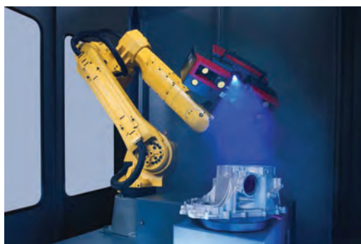
Obr. 5: Automatizovaná kontrola pomocí skeneru [2]
