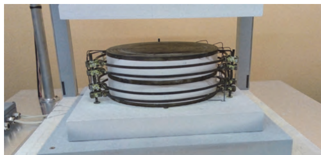
Obr. 3: Pohled do nitra přístroje GHP během instalace zkušebních vzorků
